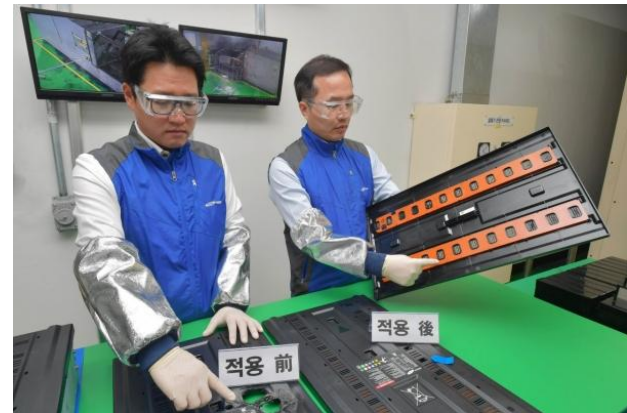
Демонстрация сотрудниками Samsung SDI крышек модулей ESS с установленными пожаротушащими элементами
