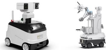
Робот для внутреннего осмотра подстанций и управления распределительным устройством
